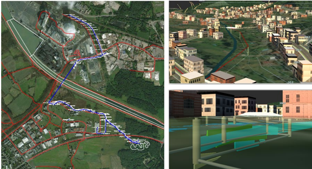
Abbildung 14: Grafische Darstellung der Kanaldaten des SAL in BIM
