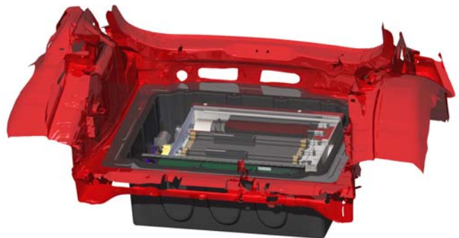
Abbildung 9: 5 kW RMFC System (SerEnergy AS) und CAD Modell vom Einbau der RMFC im Heck des Technologieträgers Audi A1 Sportsback.
